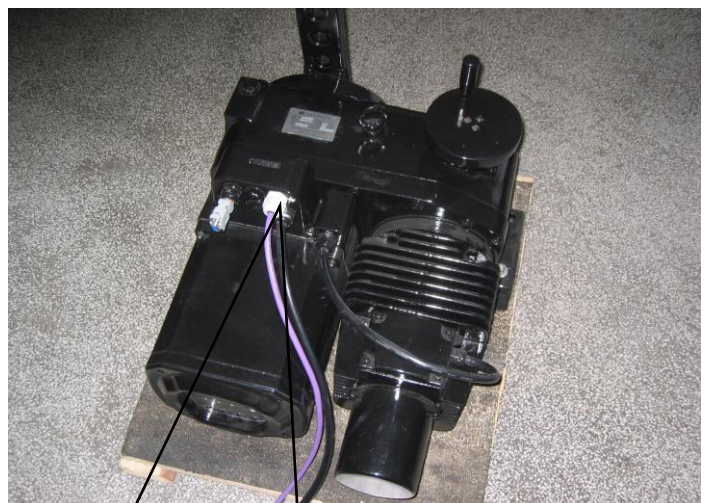
图 3-10-2 带有高 IP 等级 PROFIBUS 插座的阀门定位器
