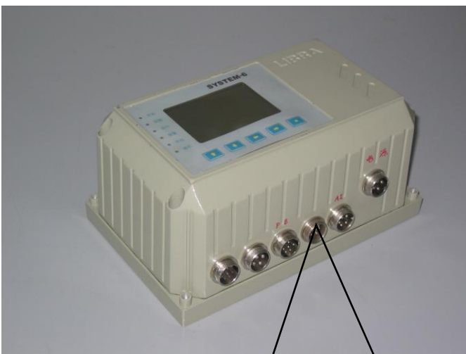
图 3-10-1 带有高 IP 等级 PROFIBUS 插座的电子称
